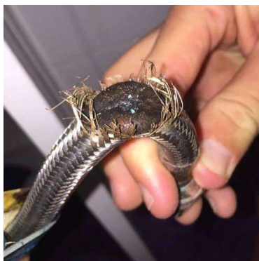
Obrázek 1 Poškození ostrým ohybem
